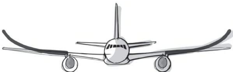
Rysunek 46. Samolot podczas lotu – siła nośna odkształca skrzydła
